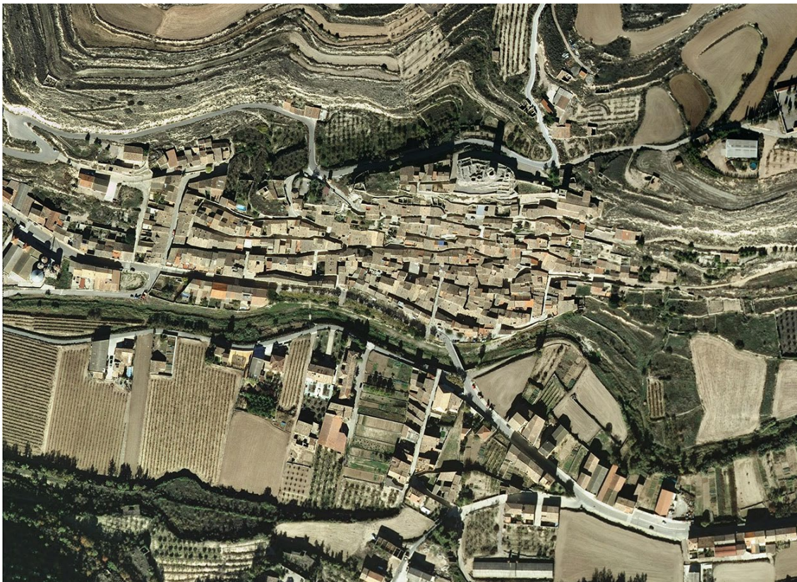
Fig. 2 Guimerà, ortofoto, escala original 1:500 formato A0. Documento que, junto al plano topográfico y catastral ha sido utilizado como base para la redacción de la base cartográfica del pueblo realizada previamente al trabajo de campo.
