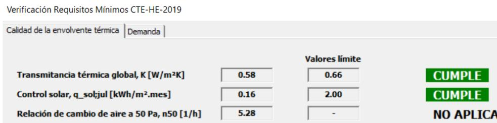
Fig. 11 Resultados del cálculo energético del edificio rehabilitado. Fuente: Material de elaboración propia (2022)
