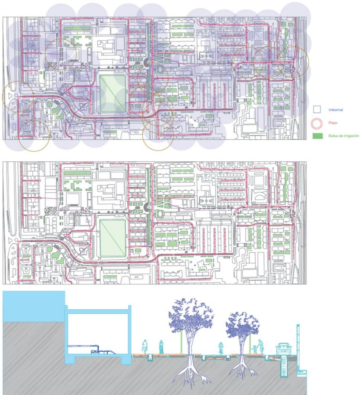
Fig. 7 Trazado y esquema de ejecución de alcantarillado y drenaje.
