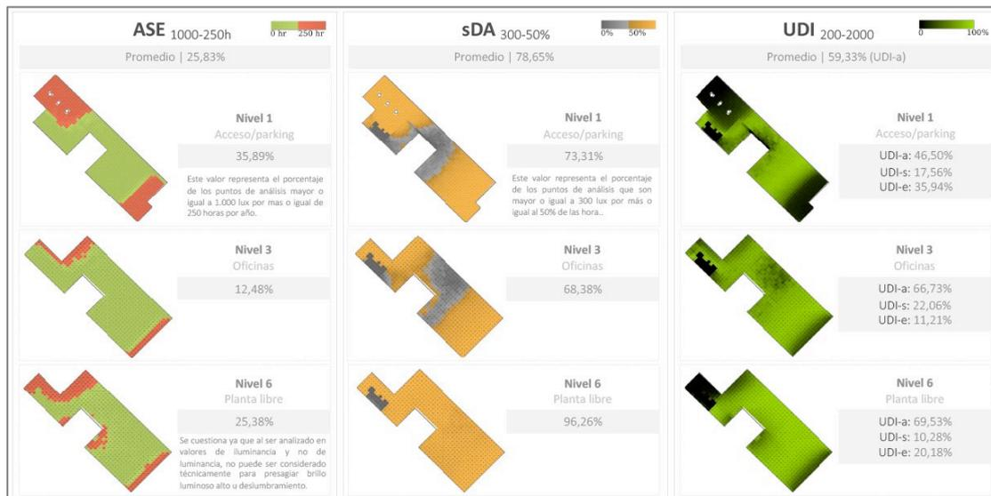
Fig. 4 Caso de estudio edificio Consorcio Antofagasta (latitud geográfica 23,5° S). Evaluación dinámica de iluminancias en Nivel 1, ingreso. Nivel 3, intermedio y Nivel 6. Según los indicadores, exposición solar anual ASE<sub>100-250h</sub>. Autonomía espacial de la luz diurna, sDA<sub>300-50%</sub>. Iluminancia diurna útil, UDI<sub>200-2000</sub>. Fuente: Archivo de la asignatura electiva de especialización, trabajo uno de Diego Carvajal + Samuel Moya + Patricia Pérez
