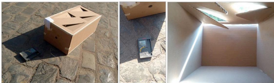
Fig. 1 Modelo 5 m x 10 m x 3,7 m de alto, escala 1:20. A la izquierda modelo ubicado junto al luxómetro en el sitio de análisis. Al centro detalle luxómetro. A la derecha vista interior propuesta de aberturas. Fuente: Archivo curso obligatorio "Principio de habitabilidad y sostenibilidad". N. Bustos, B. Flores, F. Galleguillos (2019)
