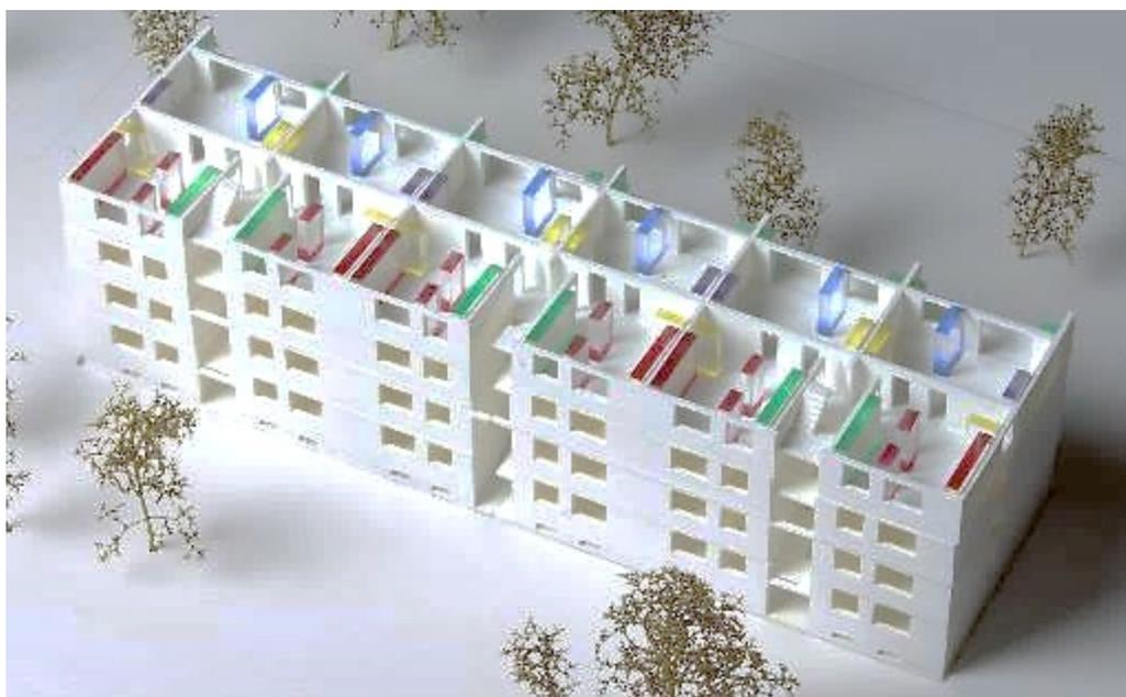
Fig. 6 Maqueta 1:200 con Piezas prototipo insertada en ABS (acrilonitrilo) por impresión 3D Bloque estandar Berliner Siedlung Autor Equipo docente,2023. Foto: L. Ammenhäuser (2024)
