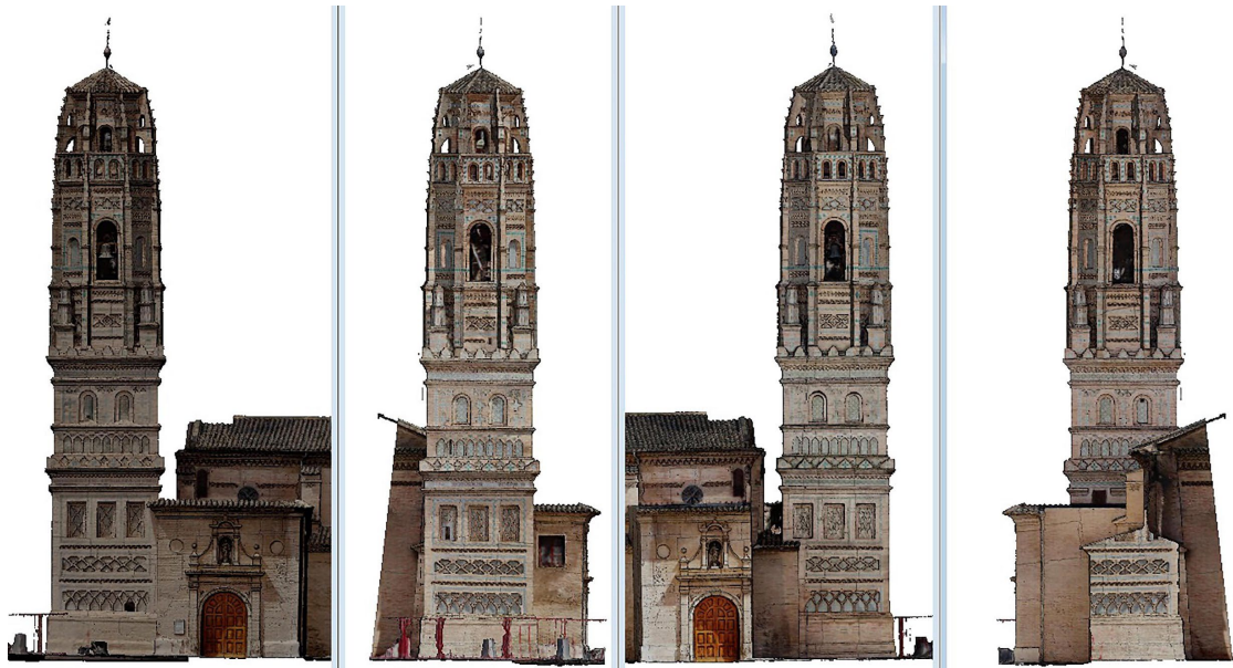
Fig. 13 Alzados extraídos del levantamiento digital de la torre de Utebo. Fuente: Propia del autor (2024)
