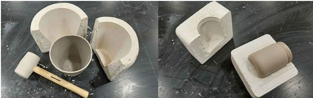
Fig. 10 Maquetas con moldes de escayola. Fuente: Goran Stevanovic
