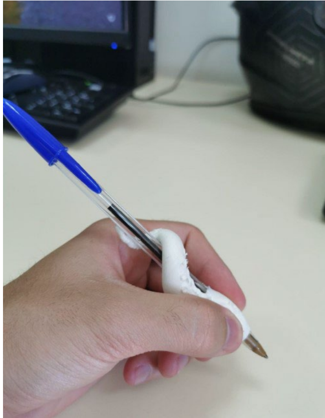
Fig. 20 Prototipo fabricado con impresión digital en material elástico. Fuente José Luis Notario Domínguez y Alice Fontana
