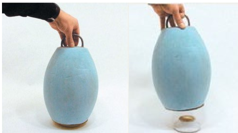
Fig. 2 Lámpara Candela Luau. Maquetas de ajuste geométrico. Espuma de Poliuretano. Fuente: Hallgrimsson, 2013
