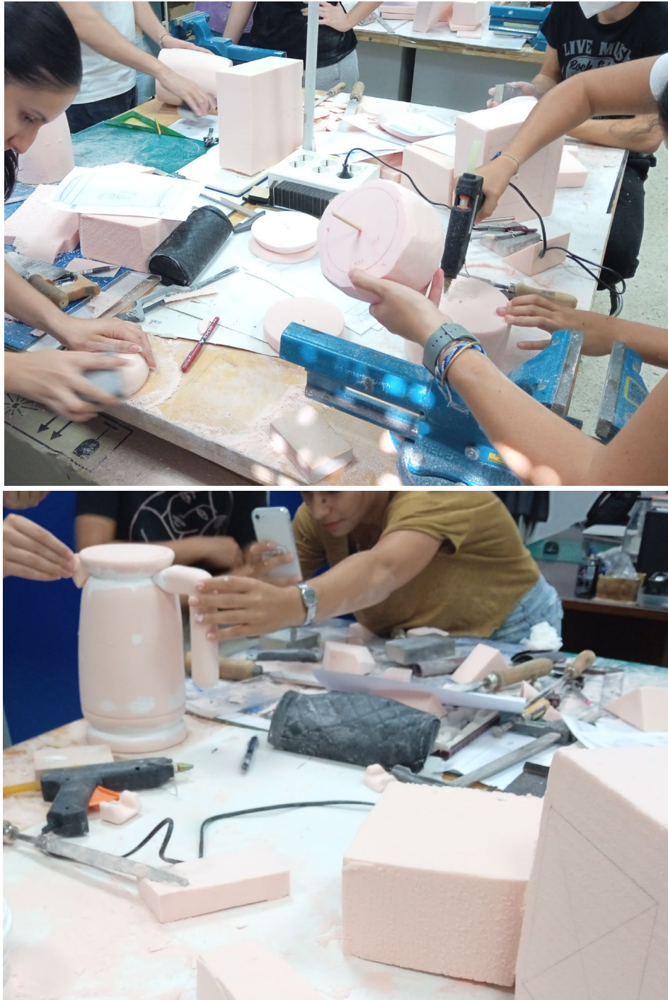
Fig. 9 Maquetas de ideación con foam. Taller de prototipos dirigido por Carlos Jiménez. Escuela Politécnica Superior de Sevilla (2023). Fuente: Elaboración propia
