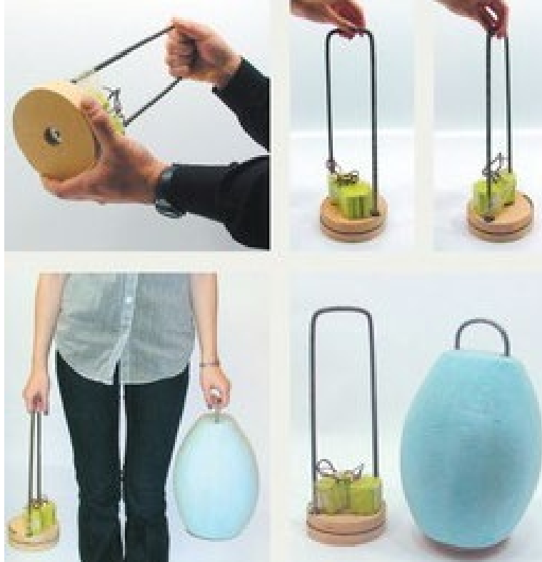
Fig. 3 Lámpara Candela Luau. Maquetas de ajuste del peso del mecanismo. Fuente: Hallgrimsson, 2013
