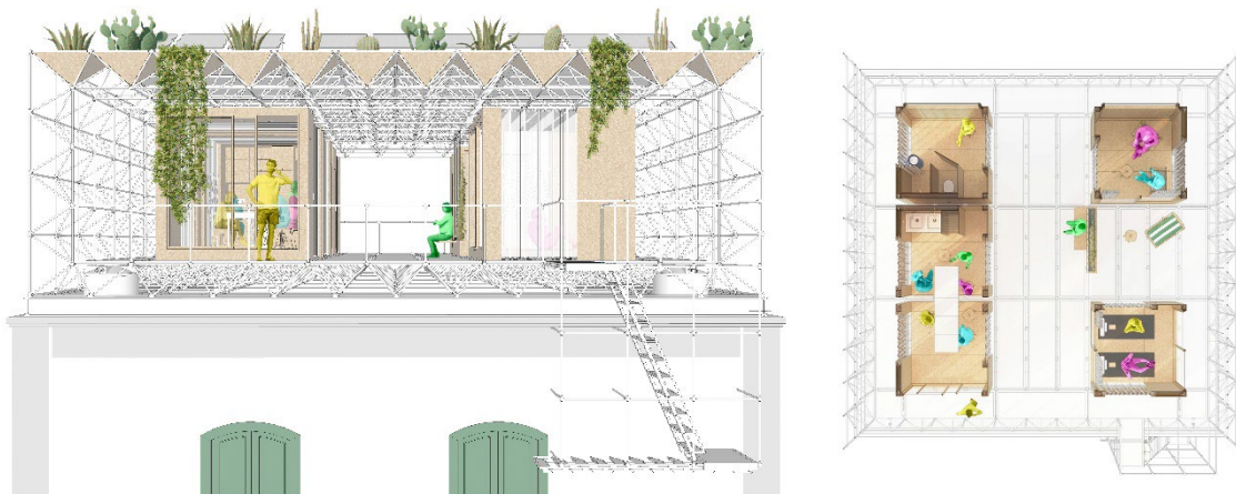
Fig. 9 (izquierda) Intervención en azoteas vacantes/segundas plantas sin construir (EA). Estructura ligera autoportante que envuelve el perímetro existente y permite alojar y colgar módulos reconfigurables sobre una plataforma común. (derecha). Planta de distribución de módulos modular conectados por espacio intermedio compartido que funciona como estancia pública y área de encuentro vecinal. Fuente: Genaro Capogrosso y Sara Reale (2024)
