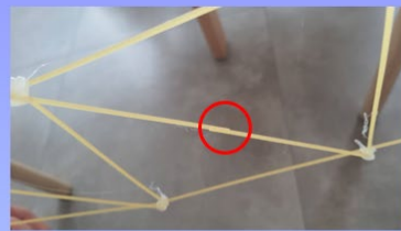
Celosía Howe diagonal trabaja a compresión
