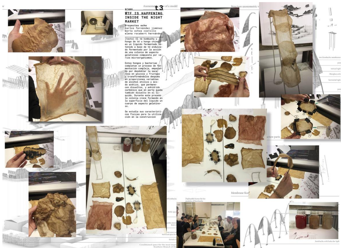
Fig. 5 Muestra de un prototipo textil biológico formado por la fermentación del hongo Kombucha. Mayo de 2018.
