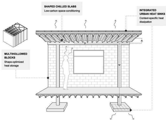
▲ FIG. 1. A través del estudio de tres elementos constructivos multifuncionales, esta tesis cuantifica las ventajas medioambientales de integrar estrategias pasivas de refrigeración como la inercia térmica, el enfriamiento radiativo o la climatización geotérmica en el diseño arquitectónico.
