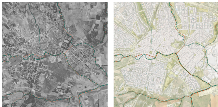
Fig. 02. Fragment indicatiu del procés de restitució gràfica de les traces d'escolament de l'aigua al municipi de Sant Cugat del Vallès.
