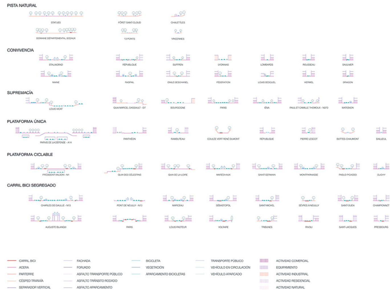
FIG. 07 Catálogo de secciones ciclables de París en relación a su tipología de vía Fuente: Elaboración propia
