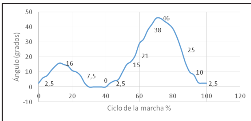
Figura 4. Ángulo versus ciclo de la marcha de la articulación de rodilla de una caminata normal.
