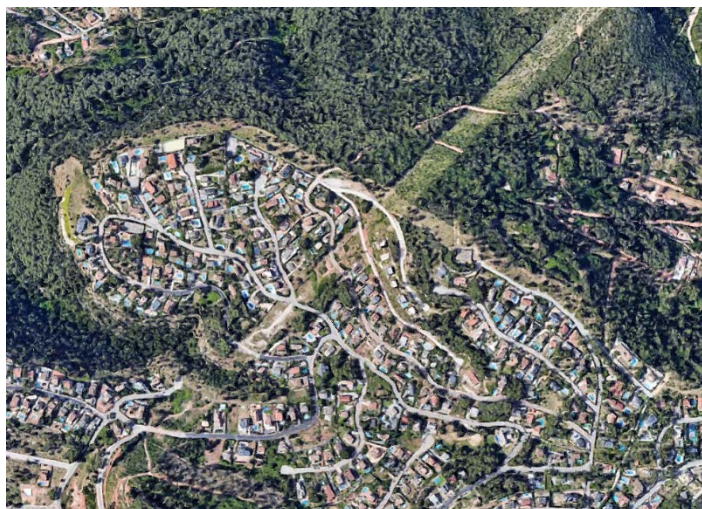
Fig. 4 Ejemplo de infraestructuras preventivas de incendios forestales: franja de protección alrededor de la urbanización y franja bajo línea eléctrica. Fuente: Google maps
