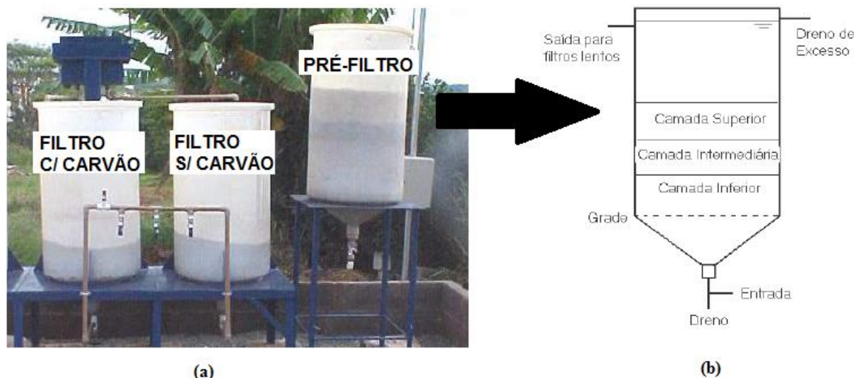
Fig. 3: Vista do sistema antes da pintura (3a) e um esboço das separações de camadas internas.
