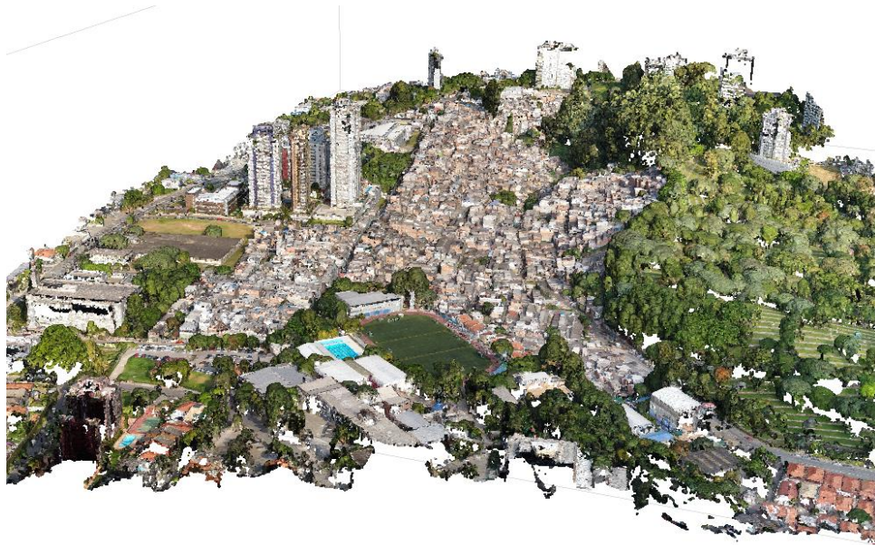
Fig. 08 Nuvem de pontos da favela Jardim Colombo, resultante de voo realizado com drone (WOLFENBERG; DIMITROV, 2019)
