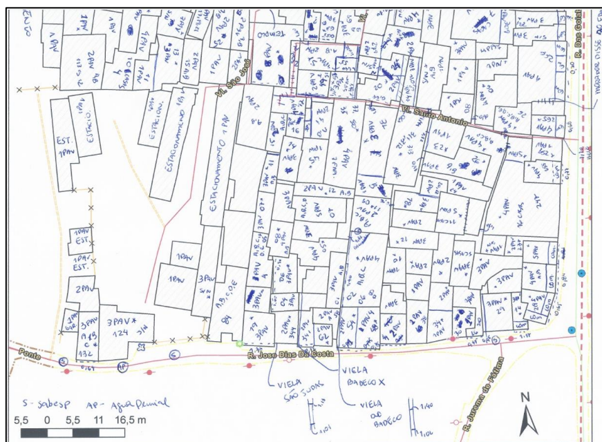
Fig. 07 Exemplo de croqui realizado em campo na fase de reambulação do Jardim Colombo (WOLFENBERG; DIMITROV, 2019)
