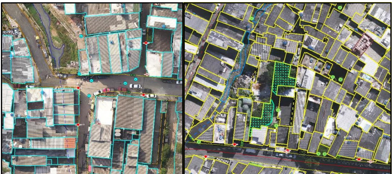
Fig. 04 Trechos das restituições preliminares sobre as ortoimagens do Jardim Colombo a esquerda e do Antonico, a direita ((WOLFENBERG; DIMITROV, 2019, 2020)
