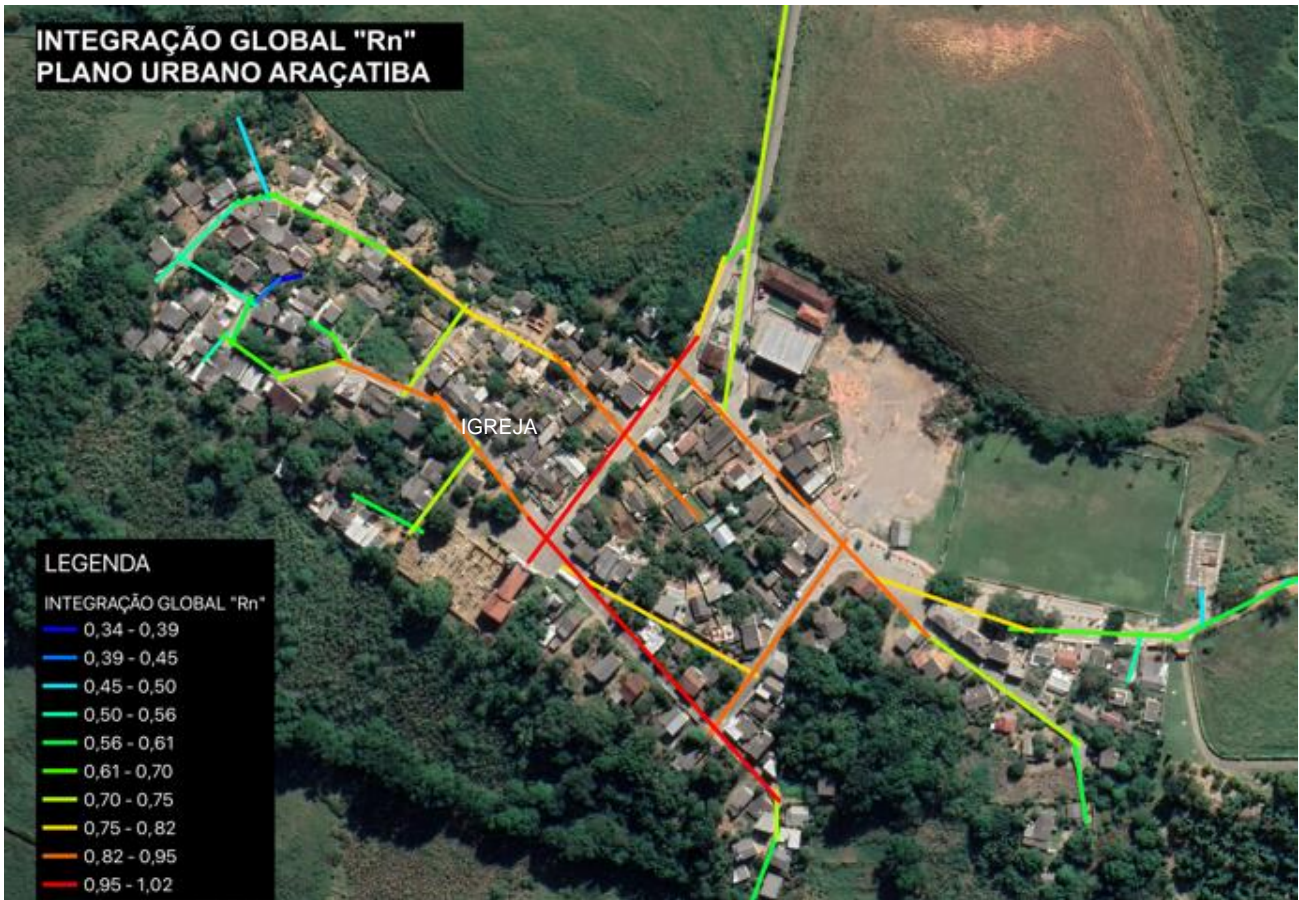
Fig. 3: Variável de integração global "Rn" no mapa axial - Araçatiba. Fonte: Elaboração própria com base em dados Google Earth/GIS (2022).
