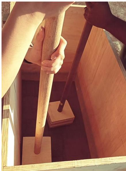
Fig. 15: Prensagem manual da massa em fôrma
