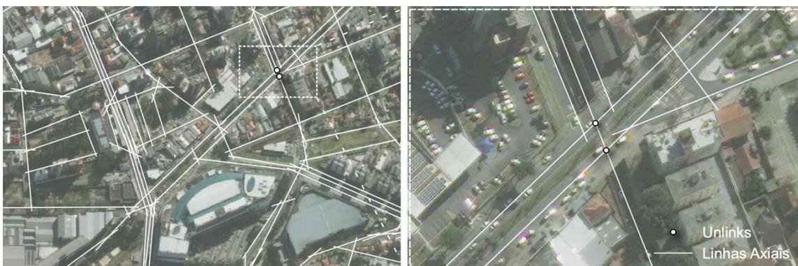
Fig. 4: Linhas axiais sobre imagem aérea e ampliação de unlinks pontuados devido à existência de uma trincheira. Fonte: Autora (2022), Equipe Colaboradores SE (2006-2022), Esri Images (2022), elaboração: Autora (2022).
