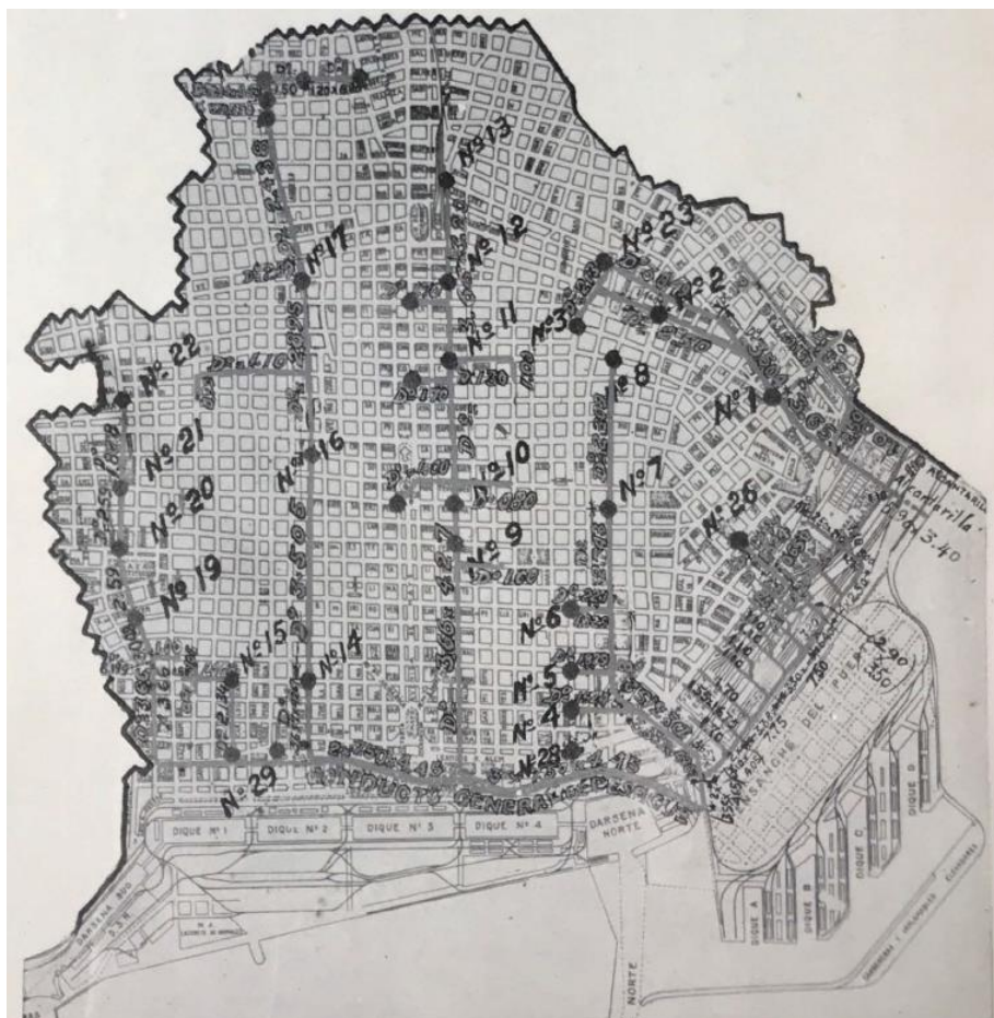
Figura 8: Radio Antiguo de Buenos Aires destacando el sistema de desagüe unitario y sus cámaras reguladoras. Fuente: Ortiz, G (1937:596)
