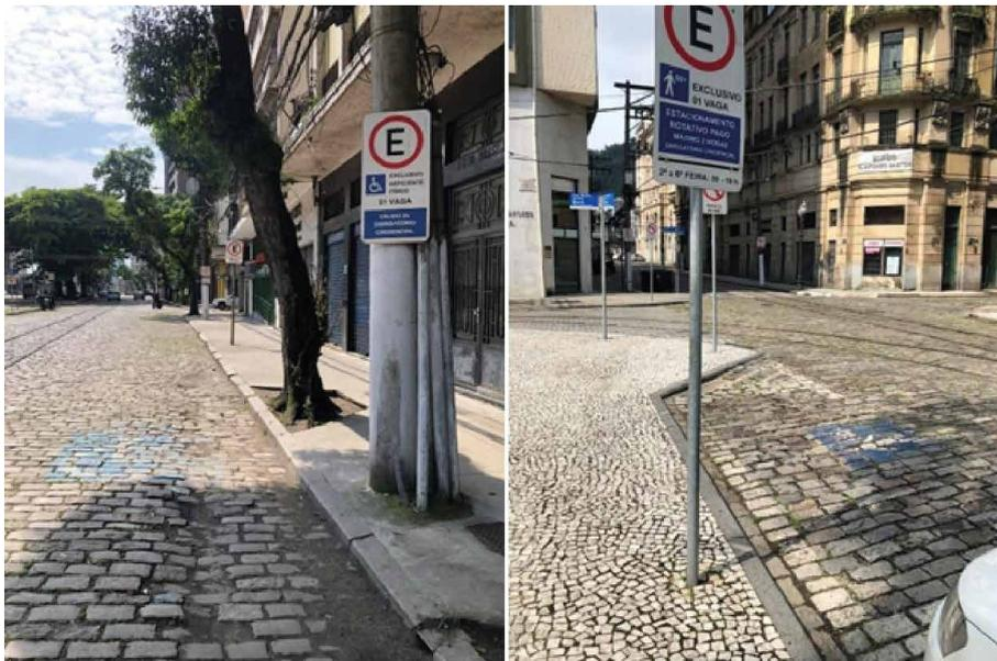
Figs. 12 e 13 - Vaga PCD e idoso sem ligação com uma rota acessível, pedestres expostos à circulação de veículos e com pisos trepidantes.
