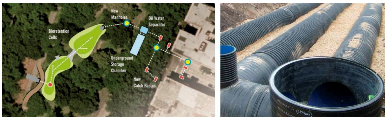
Fig. 01: Sistema de microdrenagem sustentável. Fonte: NYC (2022).
