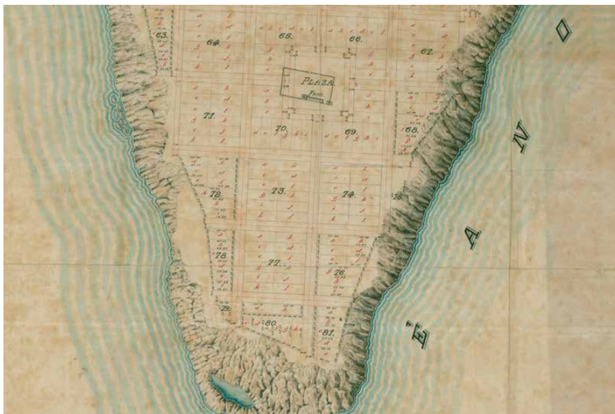
Fig. 3 Extremo sur de la península en el trazado del Ing. Surroca (1890). Se aprecia que los predios particulares terminan sobre las rocas sin ningún tipo de calle de circunvalación entre la costa y los padrones generados. Fuente: Registro Nacional de Planos de Mensura. Plano CPV 101.
